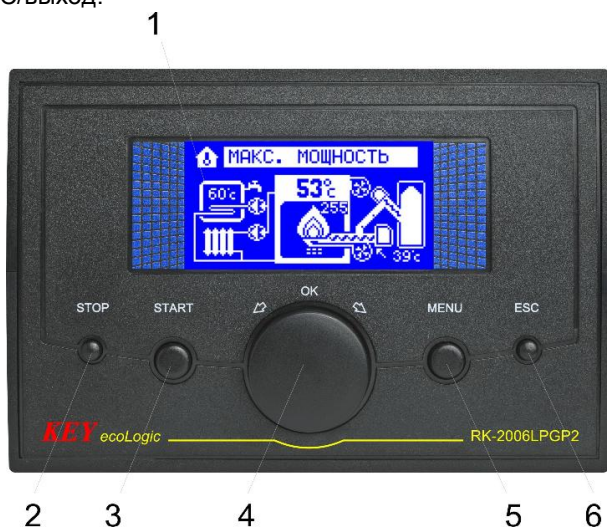
Рисунок 1. Передняя панель регулятора RK-2006LPGP2.
