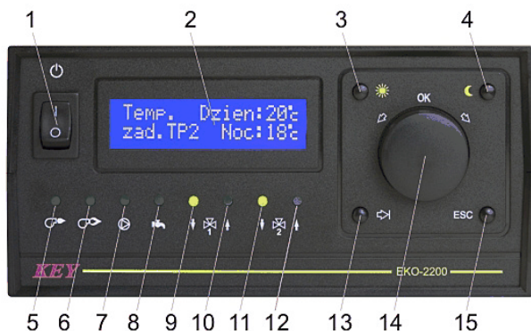
Rysunek 1. Wygląd płyty czołowej regulatora EKO-2200
